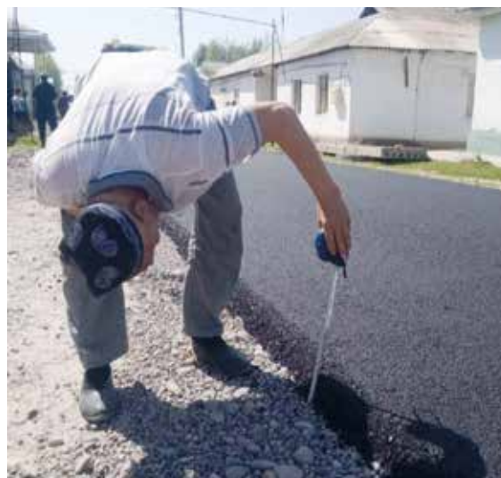
1-расм. Фуқаро асфалтланган йўлнинг бетон қалинлигини ўлчamoқда.
